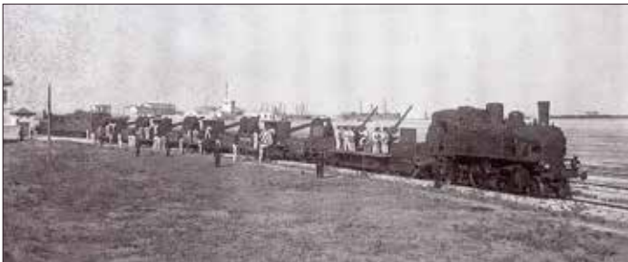
Ein italienischer Panzerzug in Manfredonia 1916. Die Waggons tragen 4 – 15,2 cm Seezielkanonen und 2 – 7,6 cm Flak. Vorne eine Lok FS 875, am Zugende eine FS 290.
