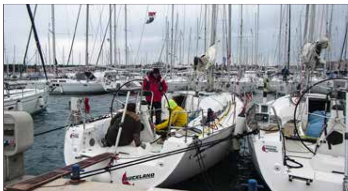
Die AUCKLAND eine Bavaria 42 match hat 12,46 m Länge und beachtliche 7.400 kg. Großsegel mit 50 m 2 und Spinnaker mit 125 m 2 sind auch nicht gerade Taschentücher.
