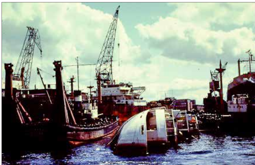
Bild 13: Beispiel Stabilitätsversagen – Kentern Kühlschiff 1964
