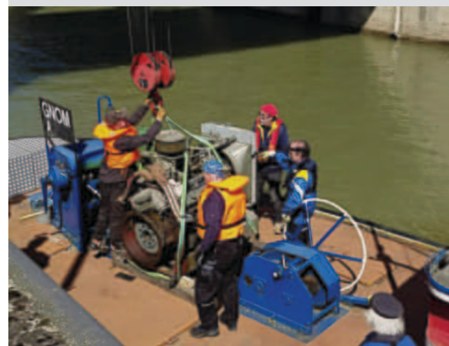
Bild 2: Nach Anheben durch den Kraftwerkskran steht die Last bereits Augenblicke später sicher an ihrem Platz am Deck des GNOM und muss nur noch verzurrt werden. (Bild: Michael Wild)
