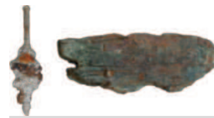
Bild 3: Links: Ein Eisenbolzen der W.J.C., der das Kielschwein mit einem Teil Totholz oberhalb des Kiels verband. Da das Kielschwein aus Kiefer bestand und deswegen deutlich schneller verrottete, ist der obere Teil des Bolzens frei sichtbar, wogegen der untere Teil mit Eichenholz verkrustet ist (Länge 43 cm). – Rechts: Ein Stück Totholz vom Bug der W.J.C. (77 cm).
