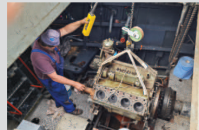
Bild 5: Nun war die »neue« Antriebsmaschine bereit, um – wiederum mit dem Bordkran des Schlepps – in die richtige Position im Maschinenraum des längsseits verhefteten GNOM gehoben zu werden.
