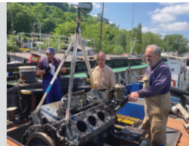
Bild 4: Nach vielen Arbeitsstunden des Mechaniker-Teams wurde die zum Einbau vorbereitete Maschine aus dem Laderaum 4 erhoben. (Bild: Stephan Kleibel)
