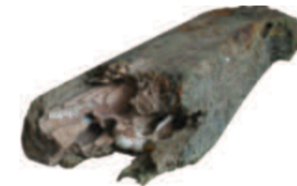
Bild 6: Von »Schiffsbohrwürmern« (teredo navalis) zerrissenes Holzstück von W.J.C. Obwohl diese Organismen landläufig als »Würmer« bezeichnet werden, sind sie tatsächlich Weichtiere (Mollusken). Daher rührt auch die muschelförmige Höhle, in der das Tier wohnt (Fundstück mit 57 x 11 cm).
