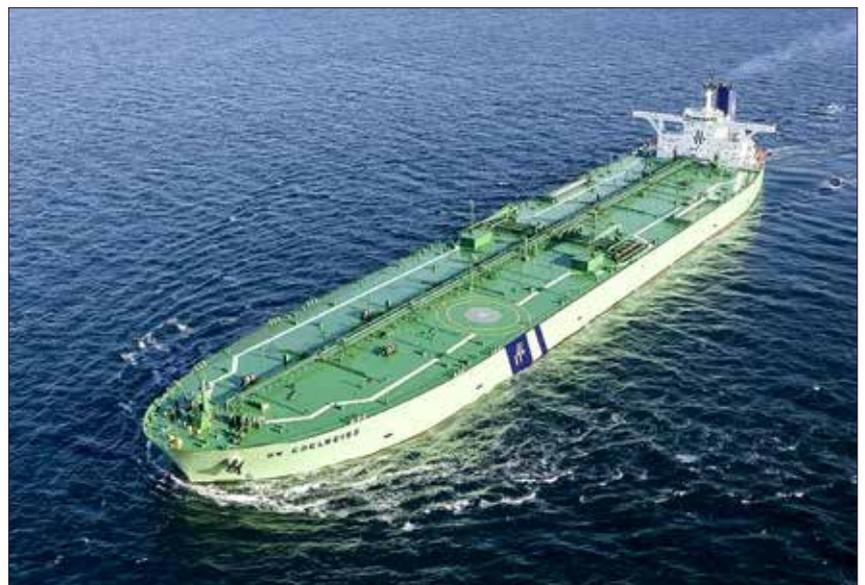
Eine Luftaufnahme der „BW Edelweiss“ verdeutlicht die enormen Dimensionen: 332 m lang, 58 m breit und 301.102 t Tragfähigkeit. Erst ab einem Gesamtgewicht von über 250.000 t spricht man offiziell von einem Supertanker (Foto Bergesen-Worldwide).
