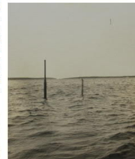
Abb. 5: Erprobung des zweiten Prototyps mit drei Spiegelsektion. U 1 fährt getaucht in der Bucht von Fasana am 7. Mai 1915
