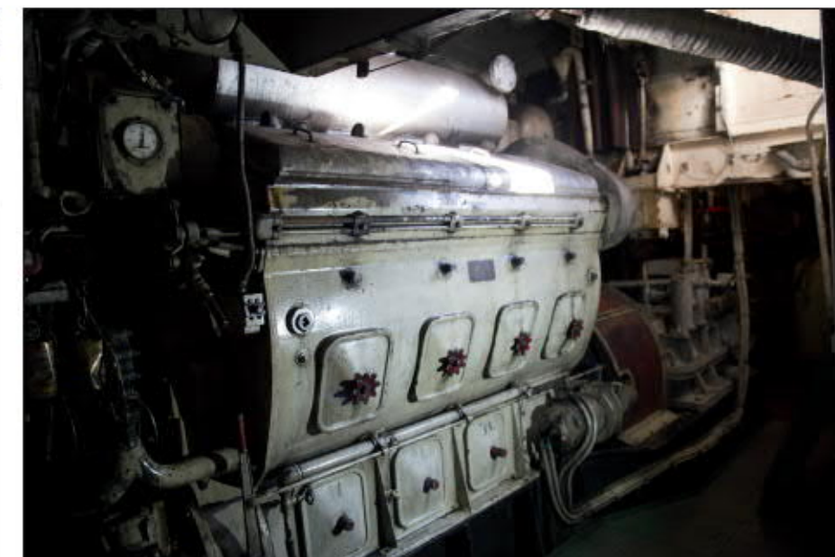
Die 750-PS-Hauptmaschine von Chrysler
