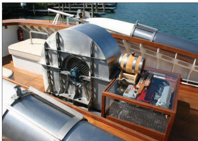
In der Mitte sitzt die Gebläseeinheit für das Luftkissen. Im Fässchen die Stärkung für die Crew.
