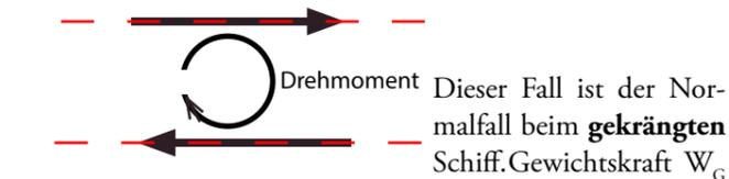
Dieser Fall ist der Normalfall beim **gekrängten Schiff**. Gewichtskraft  $W_G$  im Schwerpunkt G angreifend und Auftriebskraft  $W_A$  im Auftriebsschwerpunkt B = Volumenschwerpunkt B des Unterwasserschiffes angreifend, bilden ein Drehmoment. Es entsteht ein nach links drehendes, **aufrichtendes** Moment. Man kann sich das Schiff im Metazentrum M aufgehängt denken.
