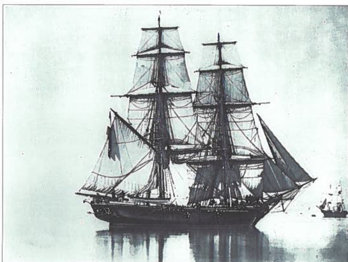
Eine Bilderserie der SAIDA als Brigg, in verschiedenen Manöver-Phasen. Ganz oben sind die Segel angeschlagen, rechts losgemacht und oben gesetzt.
